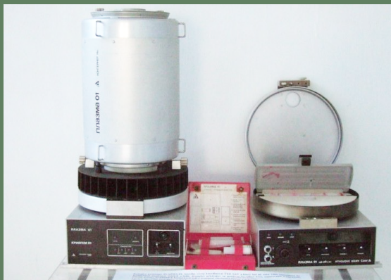
Prístroj Plazma na odber krvi kozmonautom (MUDr. L. Macho, DrSc., Ústav experimentálnej endokrinológie SAV).
